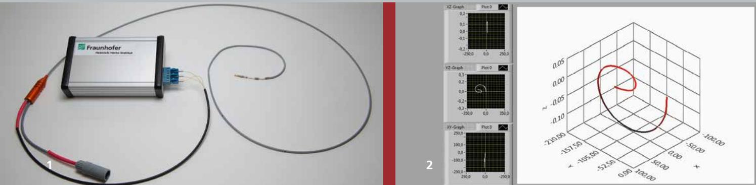
1 FBG Sensorsystem zur 3D-Profilberechnung von z. B. chirurgischen Instrumenten wie Kathetern oder Endoskopen.
